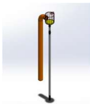
Gambar 2 Rancangan alat pemanen manggis
